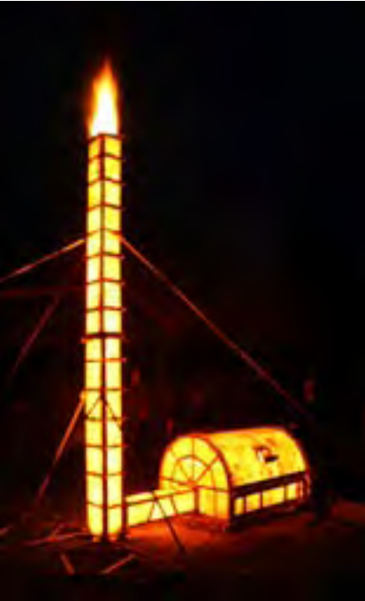
Akwarium Ognia 2006-2009, autorska konstrukcja do utrwalania ceramiki 3 x 4 m
